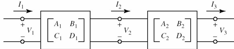
$$\begin{bmatrix} V_1 \\ I_1 \end{bmatrix} = \begin{bmatrix} A_1 & B_1 \\ C_1 & D_1 \end{bmatrix} \begin{bmatrix} V_2 \\ I_2 \end{bmatrix} \quad \begin{bmatrix} V_2 \\ I_2 \end{bmatrix} = \begin{bmatrix} A_2 & B_2 \\ C_2 & D_2 \end{bmatrix} \begin{bmatrix} V_3 \\ I_3 \end{bmatrix}$$
