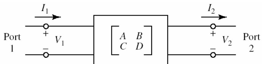
$$\begin{bmatrix} V_1 \\ I_1 \end{bmatrix} = \begin{bmatrix} A & B \\ C & D \end{bmatrix} \begin{bmatrix} V_2 \\ I_2 \end{bmatrix} \quad A = \left. \frac{V_1}{V_2} \right|_{I_2=0} \quad B = \left. \frac{V_1}{I_2} \right|_{V_2=0}$$
