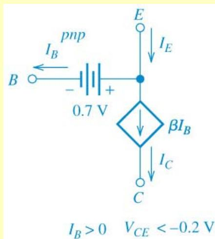
$$I_B > 0 \quad V_{CE} < -0.2 \text{ V}$$
