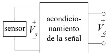
El sensor de flujo volumétrico es del tipo fuelle-LVDT (*linear voltage differential transformer*) y opera bajo el principio de Bernoulli. El sensor puede modelarse utilizando las ecuaciones mostradas junto a la
